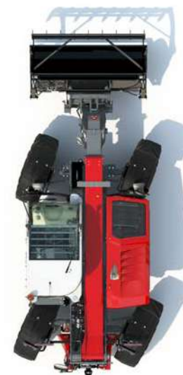
OLDALAZÓ kormányzási mód – a hatékony feltöltési és egyengetési munkákhoz, valamint falak melletti és szűk helyeken történő mozgáshoz.
